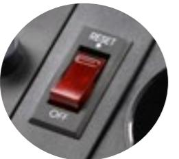
Přídavný přepínač napětí v zásuvkách
