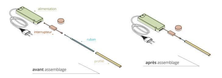
Les solutions les plus populaires sont les interrupteurs équipés de câbles (pour l'alimentation et pour le ruban LED). La répartition initiale s'effectue en deux étapes, **TACTILE/NON-TACTILE** et **AVEC RÉ GULATEUR/SANS RÉGULATEUR.** Le résultat d'une telle répartition sera de 1 maximum de 2 interrupteurs. Bien que chacun d'entre eux ait des caractéristiques légèrement différentes, celui que vous choisirez sera compatible avec les éléments sélectionnés précédemment.
