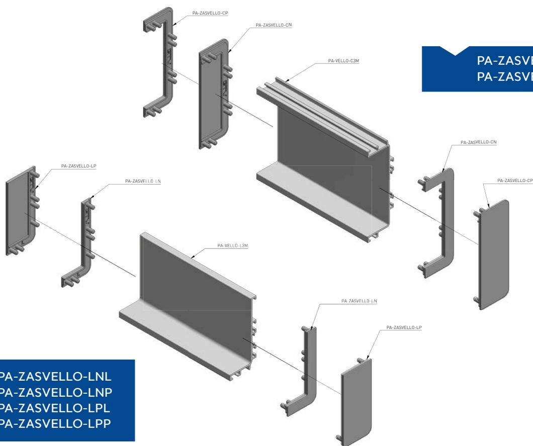
Les bouchons produits en technologie 3D sont vernis pour s'adapter parfaitement à la couleur du profilé. En cas du profilé L nous avons le bouchon droit et gauche, en version complète ou incomplète. Le bouchon pour le profilé C est symétrique, en version complète ou incomplète.
