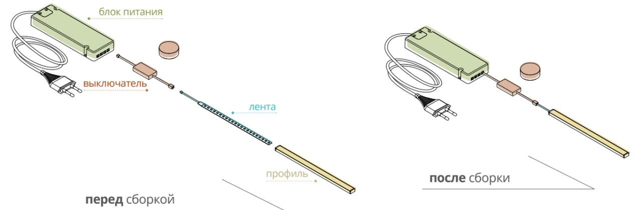
Наиболее популярные решения - выключатели с проводами (для блока питания и для светодиодной ленты). Первоначальный выбор можно осуществить между двумя видами выключателей: **СЕНСОРНЫЙ/БЕСКОНТАКТНЫЙ** и **С РЕГУЛИРОВКОЙ ЯРКОСТИ/БЕЗ РЕГУЛИРОВКИ ЯРКОСТИ**. Результатом такого выбора будет 1 или максимум 2 выключателя. Каждый из них будет иметь немного разные характеристики, но тот, который Вы выберете, будет совместим с ранее выбранными составляющими комплекта.
